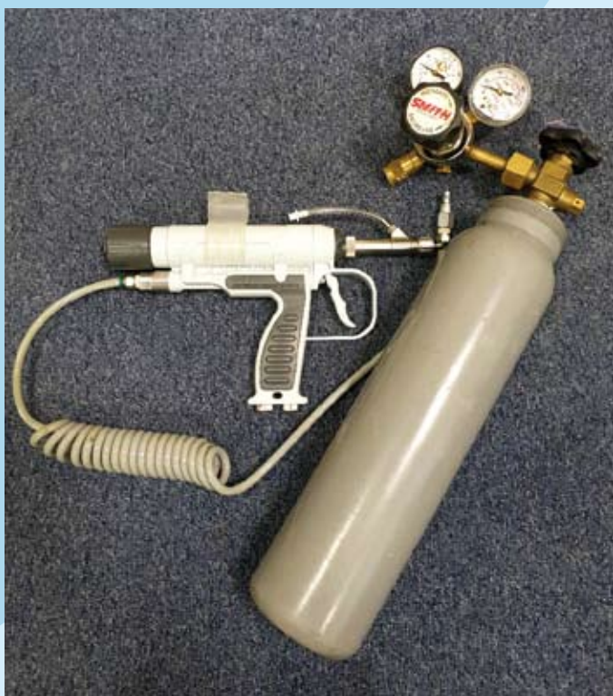
Obr. 2 Nutné vybavení pro provedení intradermální aplikace, MVDr. Jiří Mašek, s.r.o.
