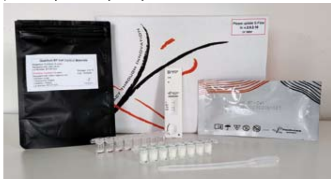
Obr. 2 QUANTUM BT-CEF test – vzorek syrové kravské mléko, detekční systém je umístěn v plastové kazetce
