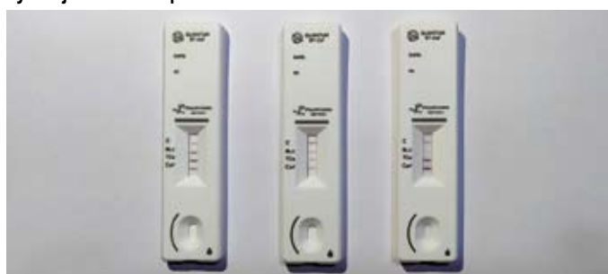
I – negativní kontrola, II – pozitivní kontrola, III – pozitivní vzorek syrového kravského mléka (účinná látka v itramamární suspenzi benzylpenicillin) C – kontrolní proužek slouží k ověření funkčnosti testu
