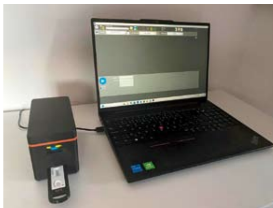
Obr. 4 QUANTUM BT-CEF test – odečet výsledků pomocí čtecího zařízení 3PR MINI
